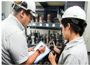
Verificación de armado perno - tuerca
