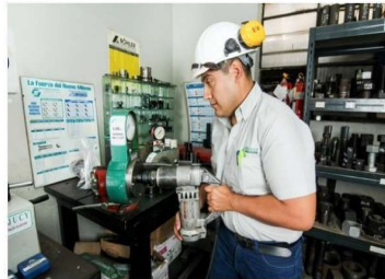
Ensayo Torque Tracción en celda de carga Skidmore
