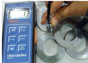
Verificación de espesor de recubrimiento
